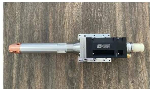
Obrázek 4 – Hlavice pro navařování vnitřních průměrů
