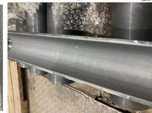
Obrázek 5 - Povrch navařeného vnitřního průměru (Řez trubky)
